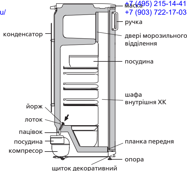
Рисунок 4 – Схема зливу талої води із ХК
