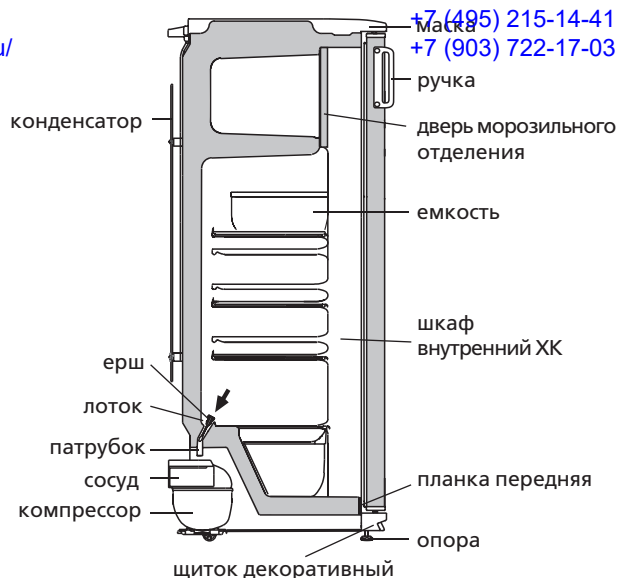
Рисунок 4 — Схема слива талой воды из ХК
